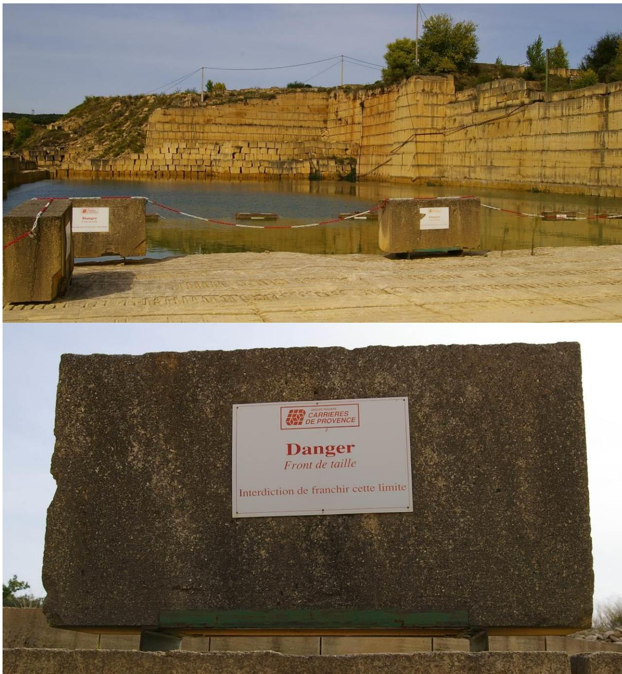
**Figure 2 : Signalisations liées au risque de chute mise en place sur le site de Carrières de Provence**
